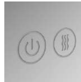
botão de desembaciador com botão on/off defoggin button with on/off button bouton de désembuage avec bouton on/off
